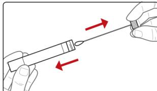
4. Izvaditi štapić sa vatiranim vrhom iz sterilne zaštitne tubice pazеći pri tome da se vatirani deo ne dodiruje rukama.
